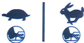
Wenn der Fußschalter nicht betätigt wird, läuft der Motor mit der niedrigsten Drehzahl im Leerlauf.
