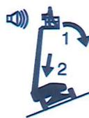
Wenn der Neigungsalarm bei bergab positionierter Plattform ertönt: Fahren Sie den Ausleger zuerst ein, und senken Sie ihn anschließend ab.
