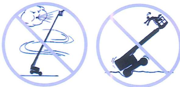
Die Maschine darf nur mit langsamer Geschwindigkeit über unebenes Gelände, Schutt, instabilen oder rutschigen Untergrund sowie in der Nähe von Bodenlöchern und Abhängen gefahren werden. Dabei ist äußerste Vorsicht anzuwenden, und die Plattform muss eingefahren sein.
