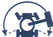
Halten Sie zum Fahren den Schalter Antriebsaktivierung nach links oder rechts gedrückt, und bewegen Sie langsam den Steuerhebel Fahren aus der Mittelstellung.
