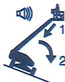
Heben Sie die Plattform nicht an, wenn die Windgeschwindigkeit mehr als 12,5 m/s beträgt. Falls die Windgeschwindigkeit bei angehobenem Ausleger 12,5 m/s überschreitet, muss der Ausleger abgesenkt und die Maschine außer Betrieb genommen werden.
