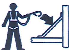
Personen auf der Arbeitsbühne müssen Sicherheitsgurte bzw. die den behördlichen Bestimmungen entsprechende Ausrüstung tragen. Befestigen Sie die Sicherungsleine an der dafür vorgesehenen Verankerung auf der Plattform.
