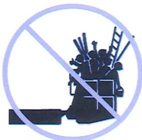
Verwenden Sie keine Leitern oder Gerüste auf der Plattform, und stützen Sie Leitern oder Gerüste nicht an der Maschine ab.
