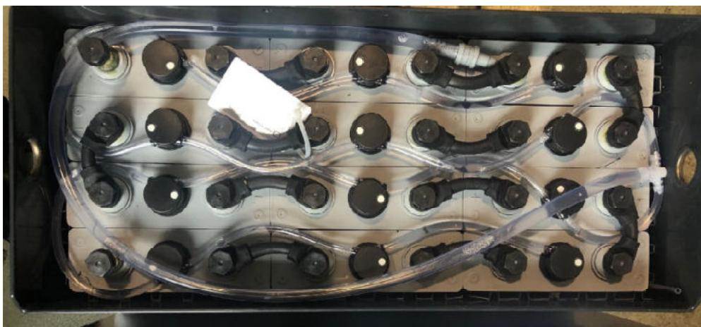
Batterie mit automatischem Befüllanschluss
