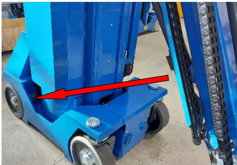
Das Typenschild befindet sich im Unterwagen, in Richtung Antriebe, links.
