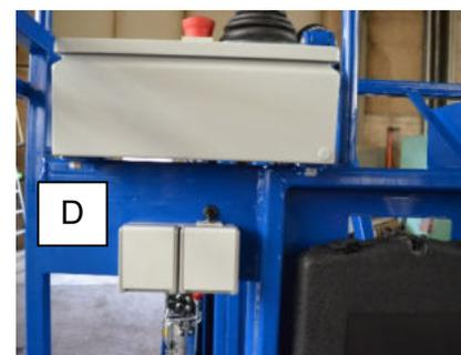
Der 230V CEE Anschluss (B) befindet sich am Turm und der Sicherungsautomat (C) oberhalb von der Netzeinspeisung (B). Vor dem Anschließen ist der gesamte Leitungsverlauf auf Beschädigungen hin zu untersuchen. Außerdem sind der Sicherungsautomat (C) und die Steckdosen (D), im Korb, auf Beschädigung zu überprüfen. Der aktuelle Ladezustand der Batterie kann an der Ladeanzeige (O) geprüft werden.
