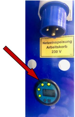
Bei entladener Batterie sind das Heben des Mastes und das Schwenken des Korbes nach einer Richtung blockiert. Das Fahren ist noch möglich um die Maschine aus dem Arbeitsbereich zu entfernen und an die Batterieladung anzuschließen.
