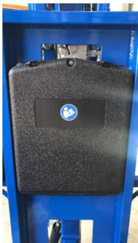
Im Korb befindet sich eine Box, in der sich das Prüfbuch, die Betriebsanleitung sowie Betriebsanleitung für Ladegerät und Batteriewartung hinterlegt sind.
