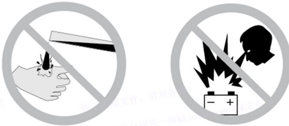
Abbildung 2-17 Schutz vor Korrosion und Explosion.
