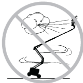
Abbildung 2-9 Es ist verboten, unter Sturmbedingungen zu arbeiten.
