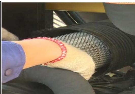
2. Lösen Sie den Clip der Außenabdeckung des Filterreinigergehäuses. Drehen Sie die Außenabdeckung und nehmen Sie sie ab.
