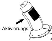
1. Halten Sie den Aktivierungsschalter am Joystick nicht gedrückt, sondern betätigen Sie direkt den Joystick: die Funktion darf nicht ausgeführt werden.
