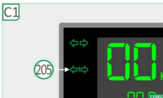
KONTROLLEUCHE (205) EINGESCHALTET: Fahrtrichtungsanzeiger des Anhängers funktionieren korrekt.
