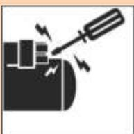
Starten Sie den Motor NICHT mit elektrischem Kurzschluss. Starten Sie den Motor und betätigen Sie die Steuerungen nur über den Steuerplatz in der Kabine.
