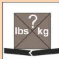
Kontrollieren Sie, ob der Positionierungspunkt stabil, eben und in der Lage ist das Gewicht der Last auszuhalten und ob er sich innerhalb der am Lastdiagramm für die Kombination Maschine/installiertes Anbaugerät befindet.
