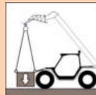
Lenken Sie die Maschine NICHT ohne die Last an den entsprechenden Punkten am Unterwagen befestigt zu haben.
