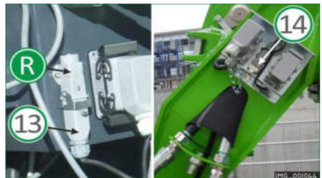
(Sofern vorhanden) den Stecker für die kontinuierliche Zufuhr (13) von der entsprechenden Steckdose am Ende des Teleskoparms der Teleskopmaschine (14) abziehen und in Ruhestellung am Anbaugerät (R) anbringen.
