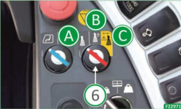
Zum Auswählen der Betriebsart der Maschine den Wahlschalter in die entsprechende Position drehen.
