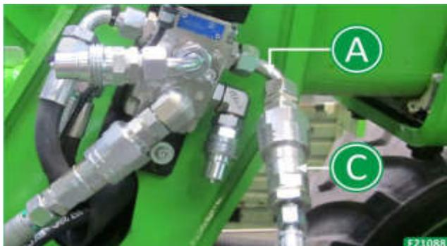
Die Taste (315) gedrückt halten und mit dem Joystick (1) den Ölfluss Richtung Hydraulikanschluss [A] leiten, um den Schnellkupplungskolben zurückzuziehen. Danach die Bedienelemente loslassen, damit der Kolben austritt.
