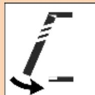
KEINE Arbeiten unter dem angehobenen Teleskoparm durchführen. Am Hubzylinder des Teleskoparms den mechanischen Sicherheitsfeststeller installieren.
