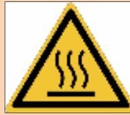
Mindestens 4 Stunden nach Abstellen des Motors abwarten, bevor die Maschine gewartet wird, um eine Berührung mit heißen Maschinenteilen auszuschließen.
