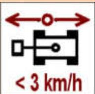
Die höchste Fahrgeschwindigkeit der Maschine während des Beförderns einer Last ist am entsprechenden Diagramm angegeben.
