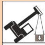
Heben Sie KEINE schwebende Last, wenn der Hebe- und Anbaugerät nicht zur Last zentriert ist, weil dadurch die Last in Schwingung versetzt wird und die Maschine der Kippgefahr ausgesetzt wird.
