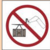
**KEINE** Lasten unter Verwendung von Seilen, Ketten oder Schlingen anheben, die an den Lastgabeln, dem Anbaurahmen oder am Teleskoparm befestigt sind.
