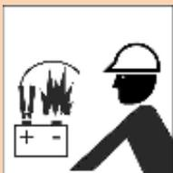
Die elektrischen Anschlüsse auf Sauberkeit und Schäden prüfen, um Kurzschlüsse oder Explosionen zu vermeiden.
