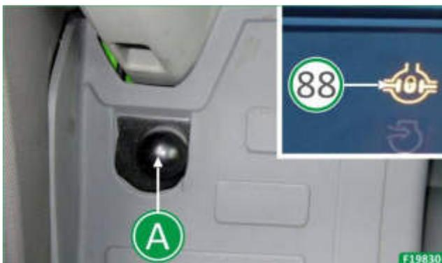
Sobald sich die Schleppbedingungen wieder stabilisiert haben die Differentialsperre durch Loslassen der Taste (A) deaktivieren, dadurch erlischt die Kontrollleuchte (87) am ARMATURENBRETT (C).
