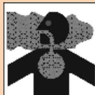
Den Motor NICHT anlassen wenn sich die Maschine in einem Bereich ohne entsprechende Belüftung befindet, da die Abgase gesundheitsschädlich sind.
