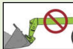
Das Aufladen mit der Schaufel bei nicht eingefahrenem Teleskoparm ist verboten.
