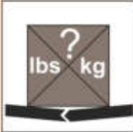
Prüfen Sie die vom Boden tragbaren Gewichts- und Druckgrenzen mit der Maschine bei voller Last, sowohl auf den Reifen als auch auf den Abstützungen (falls installiert). Siehe dazu die entsprechenden Aufkleber im ABSCHNITT 2.
