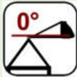
Das Anbaugerät vor dem Befördern von Lasten nivellieren.
