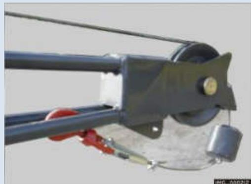
Beim Deponieren den Anbaugerät auf den Boden darauf achten, dass das Seil nicht **zerdrückt** wird.
