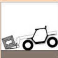
Führen Sie KEINE abrupten Bremsbewegungen während des Beförderns einer schwebenden Last durch, da sie herunterstürzen könnte.
