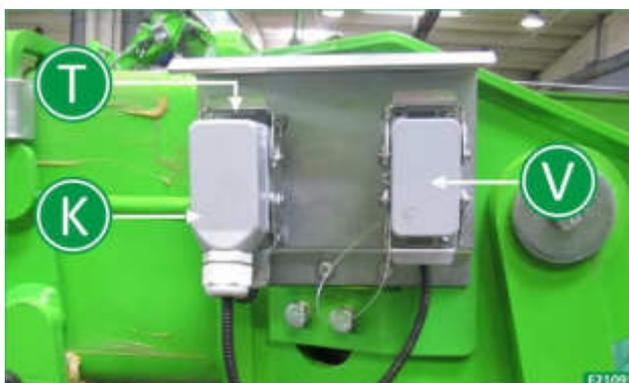
Den **Stecker (K)** aus der Ruhestellung (V) abziehen und an die Steckdose (T) anschließen.
