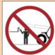
Erlauben Sie NIEMANDEM unter dem Teleskoparm der Maschine zu verweilen oder durchzugehen.
