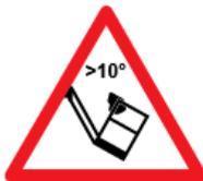
**MAX. Korbneigungswinkel (10°) überschritten:-** Der Alarm ertönt, dieses Bild wird angezeigt und alle Maschinen-funktionen werden unterbunden. Den Knopf Plattform-Nivellierung (siehe Abschnitt 4.2.1, Punkt 6) zusammen mit dem weißen Knopf benutzen, um den Winkel zu reduzieren und somit die Maschinenfunktionen wieder herzustellen.
