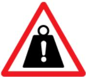
**Zulässige Betriebslast überschritten:-** Der Alarm ertönt und dieses Bild wird angezeigt. Die maximal zulässige Betriebslast (280 kg) wurde überschritten. Sofort alle überflüssigen Gegenstände **sicher** von der Plattform entfernen, um Maschinenfunktionen wieder herzustellen.
