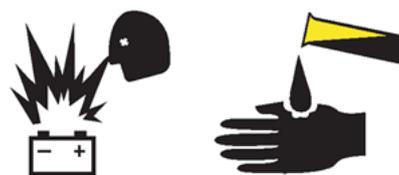
Die Batterien enthalten Säure. Bei Eingriffen an den Batterien immer Schutzkleidung und eine Schutzbrille tragen.
