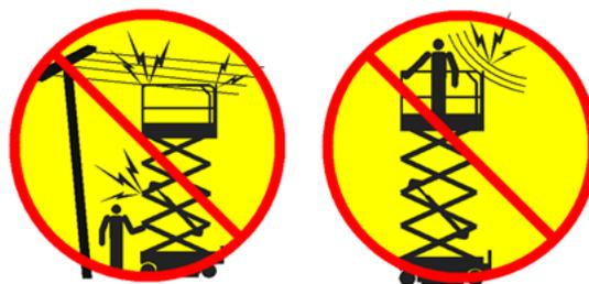
Von Stromleitungen und elektrischen Geräten einen Sicherheitsabstand einhalten, der den anwendbaren Gesetzen und den Werten der folgenden Tabelle entspricht.
