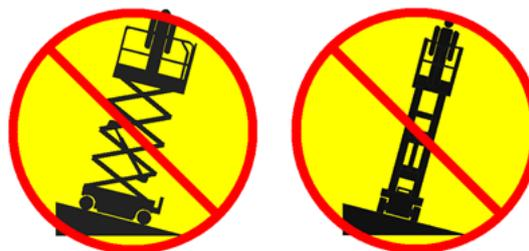
Den Kippalarm nicht als Neigungsanzeiger benutzen. Der akustische Alarm bei Kippgefahr wird auf dem Untergestell und in der Plattform aktiviert, wenn die Maschine schräg steht.
