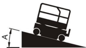
Maximale Steigfähigkeit, eingefahrene Position
