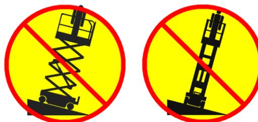
Der Kippalarm ist keine verlässliche Anzeige für gerade Ausrichtung. Der Kippalarm ertönt am Chassis und in der Plattform, wenn sich die Maschine auf einem schrägen Untergrund befindet.
