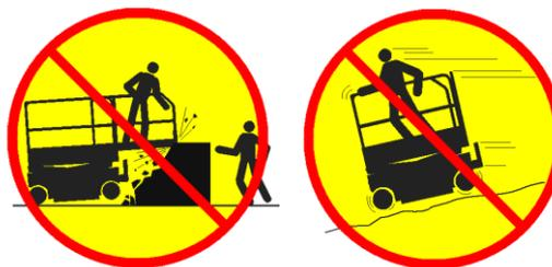
Die Fahrgeschwindigkeit muss an die Bodenverhältnisse, den Verkehr, das Gefälle, die Aufenthaltsposition des Personals und andere Faktoren, die zu einer Kollision führen könnten, angepasst werden.
