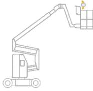
1. Betätigen Sie den Aktivierungsschalter und gleichzeitig den Schalter zum Nivellieren der Plattform nach oben: die Plattform wird angehoben.
