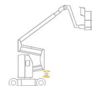
1. Betätigen Sie den Aktivierungsschalter und gleichzeitig den Schalter zum Drehen des Oberwagens nach oben: der Oberwagen dreht sich gegen den Uhrzeigersinn.
