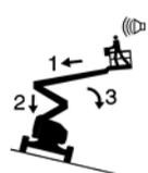
Plattform oder Last. Eine Vergrößerung der dem Wind ausgesetzten Fläche beeinträchtigt die Standfestigkeit der Maschine.
