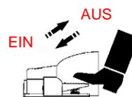
1. Lassen Sie den Fußschalter los und betätigen Sie die einzelnen Funktionsschalter/-hebel: die entsprechende Funktion wird nicht ausgeführt, und der Summer ertönt.
