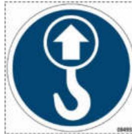
Die 4 Hebepunkte der Maschine sind durch den nebenstehenden Aufkleber gekennzeichnet.
