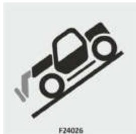
Befahren Sie Hänge mit unbeladener Maschine und Teleskoparm in der Transportposition (siehe ABSCHNITT 4).
