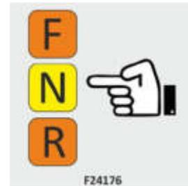
Die Neutralstellung [N] des 2-Gang-Getriebes und der Fahrtrichtung auswählen.
