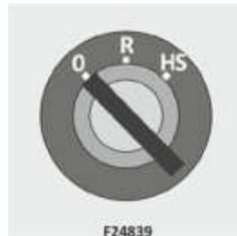
Drehen Sie den Zündschlüssel [8] auf [0] drehen, um den Motor abzustellen. Ziehen Sie den Schlüssel ab.
