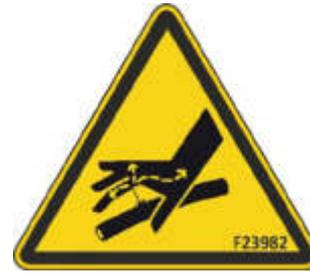
Versuchen Sie NICHT, Hydraulikleitungen oder -anschlüsse bei laufendem Motor oder unter Druck stehendem Hydrauliksystem zu reparieren bzw. festzuziehen.
