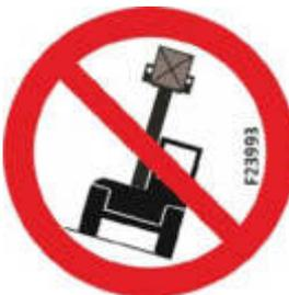
Heben Sie KEINE Last auf Steigungen an, die den Maximalwert überschreiten, der auf dem Lastdiagramm der installierten Anbaugeräte aufgeführt ist.
