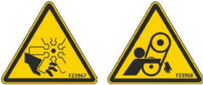
Wenn Wartungsarbeiten bei laufendem Motor ausgeführt werden, hat man sich von den beweglichen Teilen (Motorlüfter, Riemen usw.) fernzuhalten.
