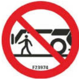
Erlauben Sie NIEMANDEM unter dem Teleskoparm der Maschine zu verweilen oder durchzugehen. Halten Sie Hände und Finger fern von den Öffnungen am Teleskoparm und vom Zylinder zum Neigen des Anbaurahmens.
