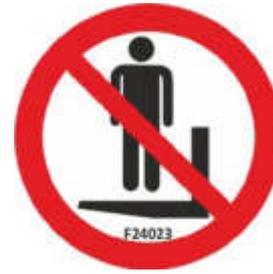
Verwenden Sie NICHT den Teleskoparm, den Anbaurahmen oder irgendein anderes Anbaugerät zum Heben von Lasten, um Personen zu transportieren oder anzuheben.
