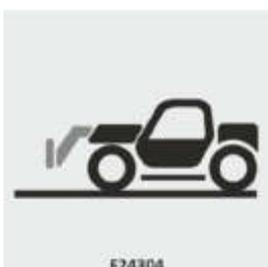
Sicherstellen, dass die Maschine auf ebenem Untergrund steht, um die Füllstände der Flüssigkeiten korrekt ermitteln zu können.
