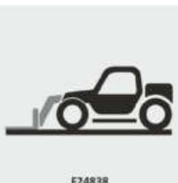
Den Teleskoparm komplett einfahren und das Anbaugerät auf den Boden absenken.
