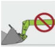
Das Aufladen mit der Schaufel bei nicht eingefahrenem Teleskoparm ist verboten.
