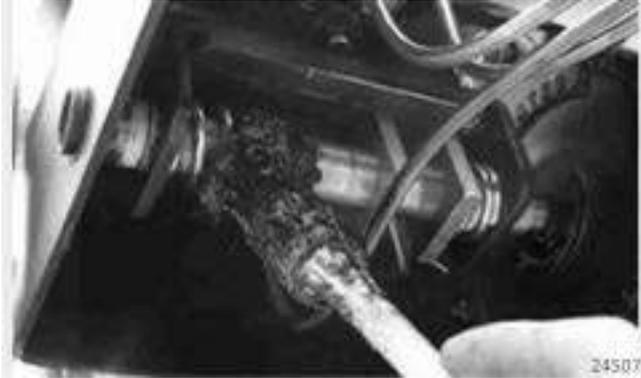
Die Schraube des Seilenschalters schmieren.
