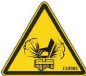
Bei laufendem Motor oder unter Druck stehendem Hydrauliksystem schrauben Sie KEINE Verschlüsse von Hydraulikkreisen ab.
