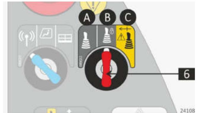
Um die Betriebsart der Maschine auszuwählen, drehen Sie den Wahlschalter [6] in die entsprechende Position:
