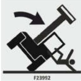
Überschreiten Sie NICHT die maximale Tragfähigkeit der Maschine.
