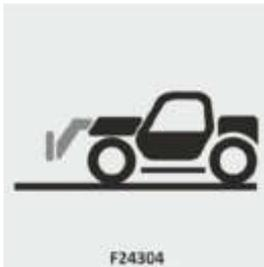
Die Maschine auf ebenem Boden abstellen. Bei Steigungen müssen die Räder mit geeigneten Unterlegkeilen gesichert werden.
