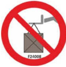
Heben oder bewegen Sie KEINE schwebenden Lasten und Verwendung von Seilen, Ketten oder Schlingen, die an den Gabelzinken, dem Anbaurahmen oder am Teleskoparm befestigt sind.
