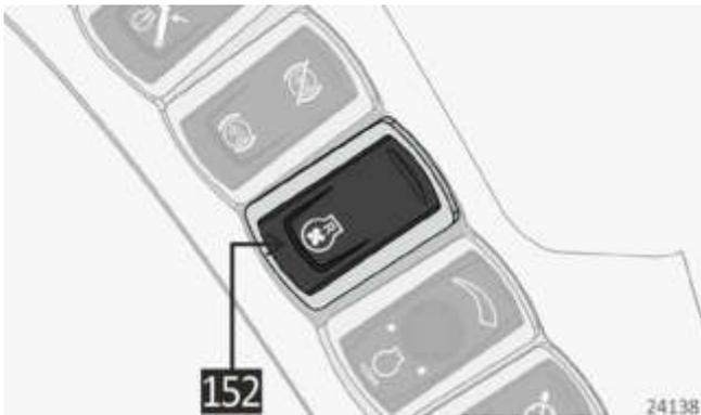
Drücken Sie den Schalter [152], um den Kühler durch Umkehrung der Drehrichtung des Kühlerlüfters des Motors zu reinigen.
