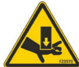
Bei laufender Maschine Hände und Füße FERN von den Stellen halten, an denen Quetschgefahr besteht (Teleskoparm, Abstützungen, usw.).
