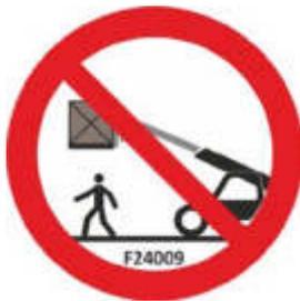
Erlauben Sie NIEMANDEM, unter der von der Maschine angehobenen Last zu verweilen oder durchzugehen.
