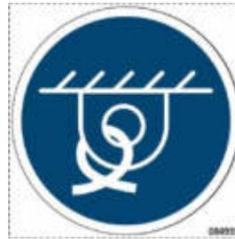
Die 4 Ankerpunkte der Maschine sind durch den nebenstehenden Aufkleber gekennzeichnet.
