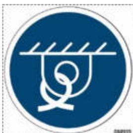
Als Abschlepppunkte der Maschine im Störfall werden die Punkte für die Verankerung am Anhänger verwendet, die durch den Aufkleber gekennzeichnet sind.
