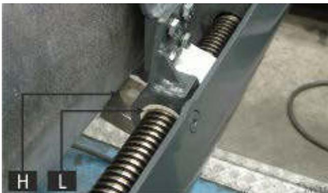
Kontrollieren Sie den Verschleiß des Seilführungsblocks [H] und der zugehörigen Buchse [L].
