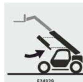
Wenn Wartungsarbeiten mit angehobenem Teleskoparm ausgeführt werden müssen, ist die hierfür vorgesehene MECHANISCHE SICHERHEITSSPERRE zu installieren (siehe entsprechender Absatz).
