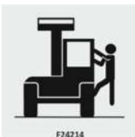
Aus der Kabine steigen und die hierfür vorgesehenen Griffe und Stufen verwenden, um stets drei Kontaktpunkte mit der Maschine zu haben.
