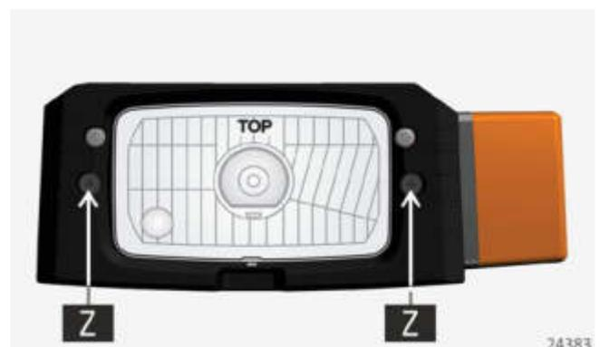
Die Schrauben [Z] drehen, bis der Lichtkegel auf der vorgesehenen Höhe liegt.
