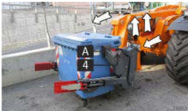
Ziehen Sie den Teleskoparm ein und senken Sie ihn ab, positionieren Sie den Anbaurahmen in vertikaler Lage.
