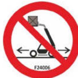
Versetzen Sie die Maschine NICHT mit einer angehobenen festen Last. Beim Transport einer festen Last beachten Sie das Lastdiagramm des installierten Anbaugeräts (siehe MODUL 2).
