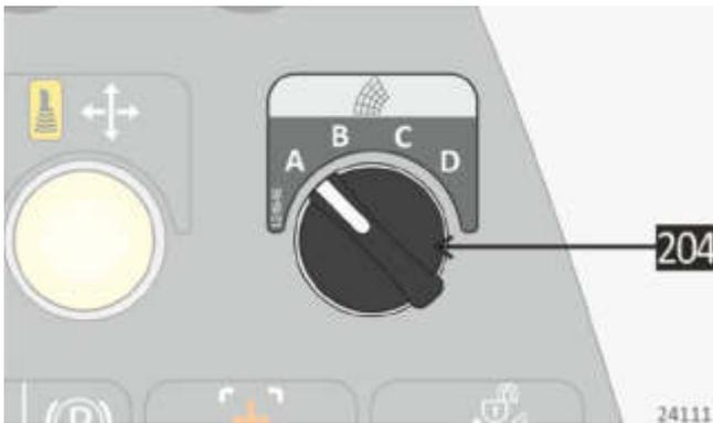
Wenn der Anbaurahmen der Maschine oder das installierte Anbaugerät nicht über den automatischen Erkennungssensor verfügen, wird der Wahlschalter (204) in der Kabine installiert, um eine manuelle Auswahl durch den Bediener zu ermöglichen.
