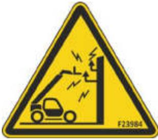
Die Maschine ist nicht elektrisch isoliert und mit keinem Kontakt- oder Annäherungsschutz in Bezug auf elektrischen Strom ausgestattet.
