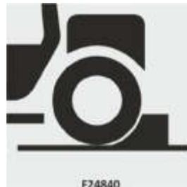
Wenn die Maschine auf einer öffentlichen Straße parkiert wird, sind die Räder mit Unterlegkeilen zu blockieren.
