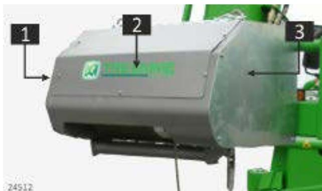
Die Schutzabdeckungen [1, 2, 3] mit einem 10 mm-Sechskantschlüssel abnehmen.
