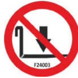
Heben Sie KEINE Lasten nur einer Gabelzinke an. Es besteht Gefahr, dass die Lastgabel beschädigt wird und die Last herunterfällt.
