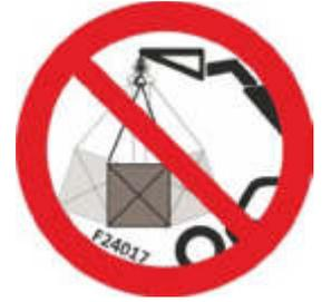
Heben Sie KEINE schwebende Last, wenn der Hebe- punkt am Anbaugerät nicht im Verhältnis zur Last zen- triert ist, weil dies zu einer Kippgefahr für die Maschi- ne führen kann.
