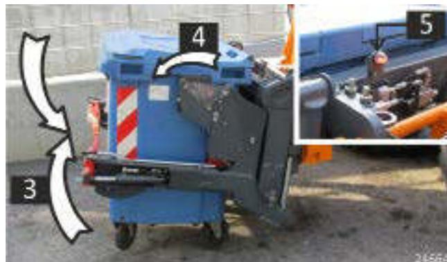
Die Mülltonne [3] mit der Steuerung [AUX2] blockieren; die Spannlaschen der Mülltonne werden geschlossen und die Arretierung sichert die Tonne [4].
