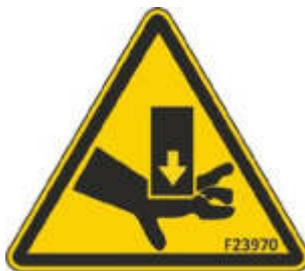
Bei laufender Maschine Sie Hände und Füße FERN von den Stellen, an denen Quetschgefahr besteht (Teleskoparm, Abstützungen, Räder usw.).
